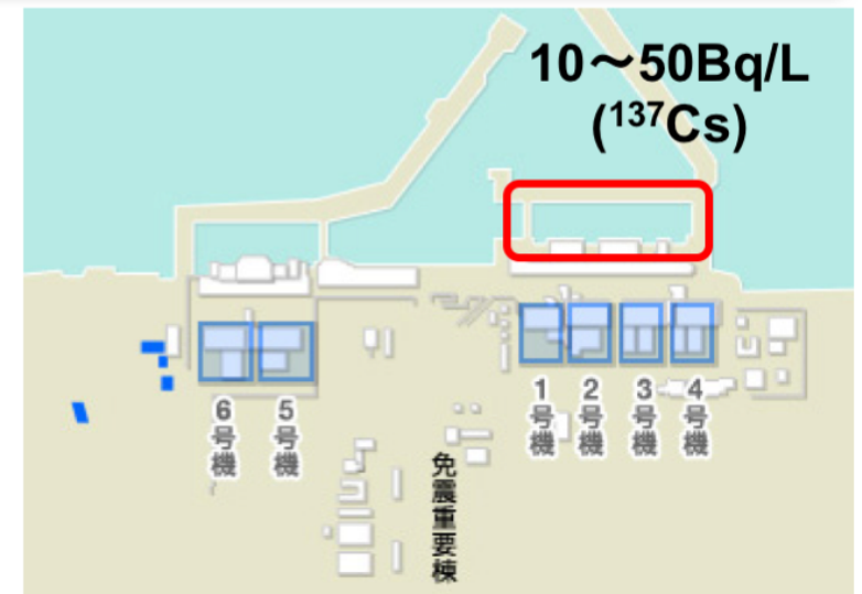
福島第一原発港湾の汚染状況 (東京電力HPより抜粋)
