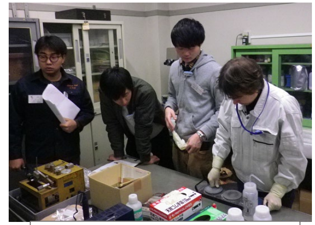
作製模擬デブリの切断・研磨
