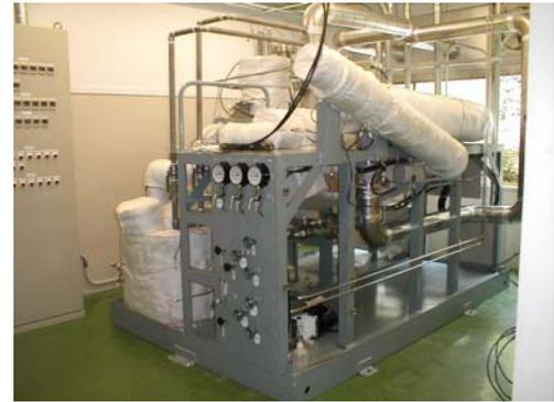
図8 鉛ビスマス循環試験装置
