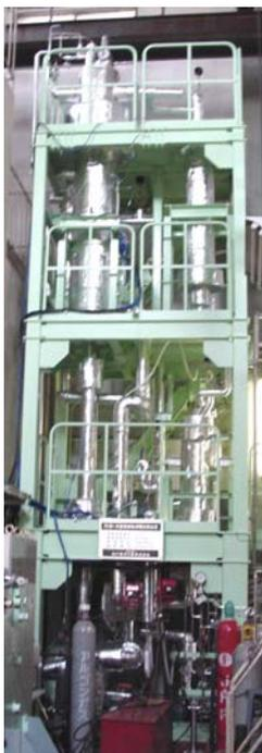
図10 鉛ビスマス-水直接接触沸騰試験装置
