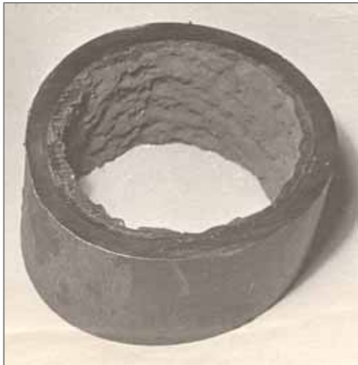
Slag on pipeline
