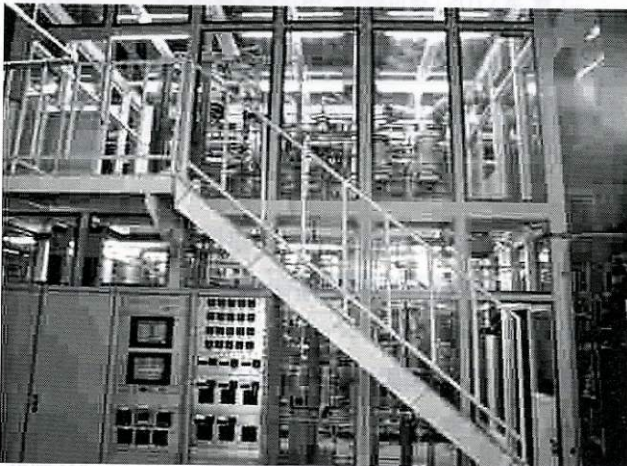
IS法水素製造試験設備(30ℓ/hr) (注)原子力機構では、世界で初めて本設備で水素を連続で30ℓ/hr取り出すことに成功している
