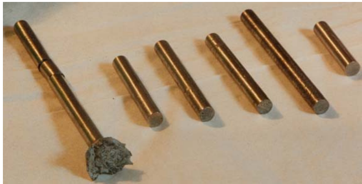
アーク溶解－重力鑄造によって製造した 照射用MA含有金属燃料ロッド 注1)
