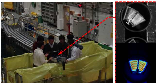
▲使用済燃料の核物質検認のためのチェレンコフ光測定 (ATR)
